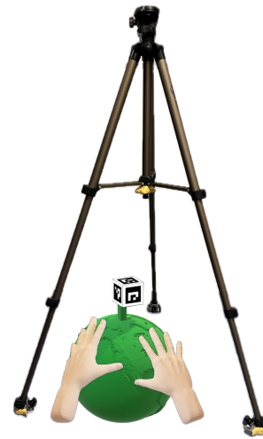
図 1: 提案手法の概要。本システムの目的は、視覚障害者が触察のみでは理解困難な情報を補完する音声説明を取得し、対象物への理解を深めることを可能にすることである。本システムは三脚に 4 台のカメラを設置し、三脚の脚部で囲まれた領域内での触察を支援する。ユーザーは探索中に手や腕で脚部に触れることで、カメラの視野範囲を認識することができる。
