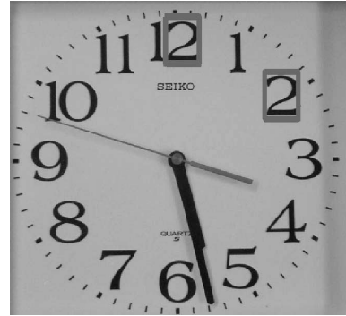
図 10 時計の文字盤 10 字種に対する認識結果：参照画像に「2」を使用
