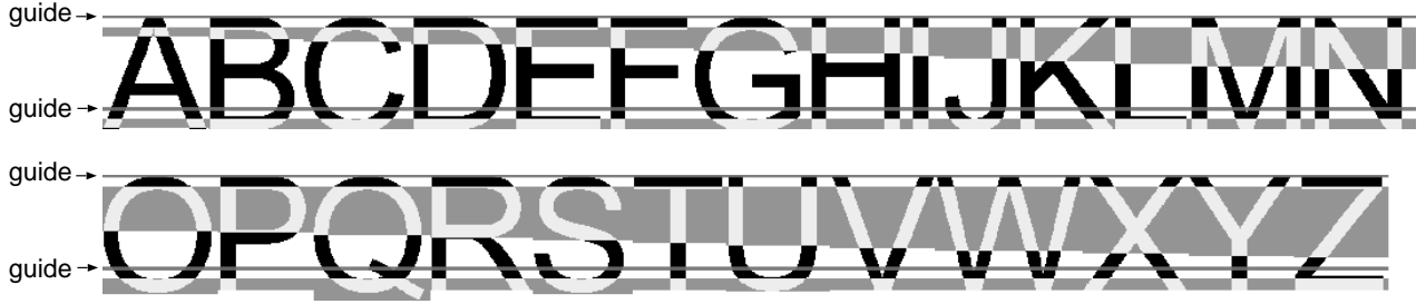
図3 複比を埋め込んだ場合の文字パターン ( K = 26 ) . これらに射影変換を施したものがテストパターンとなる .
