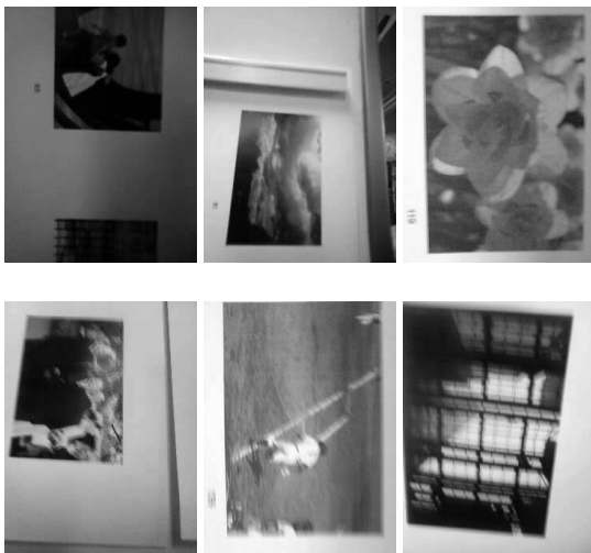
図1 カメラ付き携帯電話で撮影された検索質問画像の例。ぶれやぼけ、射影ひずみなどのために、認識が困難となっている。
